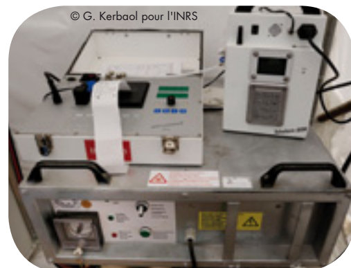
Enregistrement en continu de la dépression.
