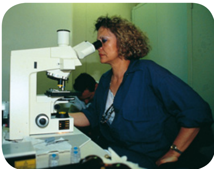
Le microscope optique à contraste de phase (MOCP) permet de compter les particules fibreuses collectées lors d'un prélèvement d'atmosphère.
