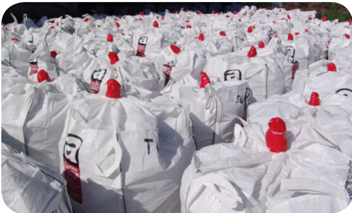
Fermeture en col de cygne des GRV.
