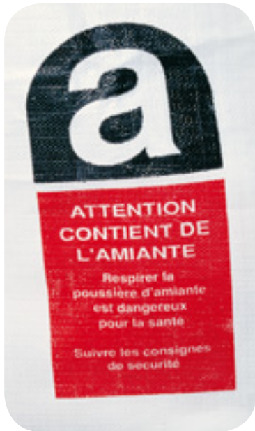
Étiquetage réglementaire pour les produits contenant de l'amiante.
