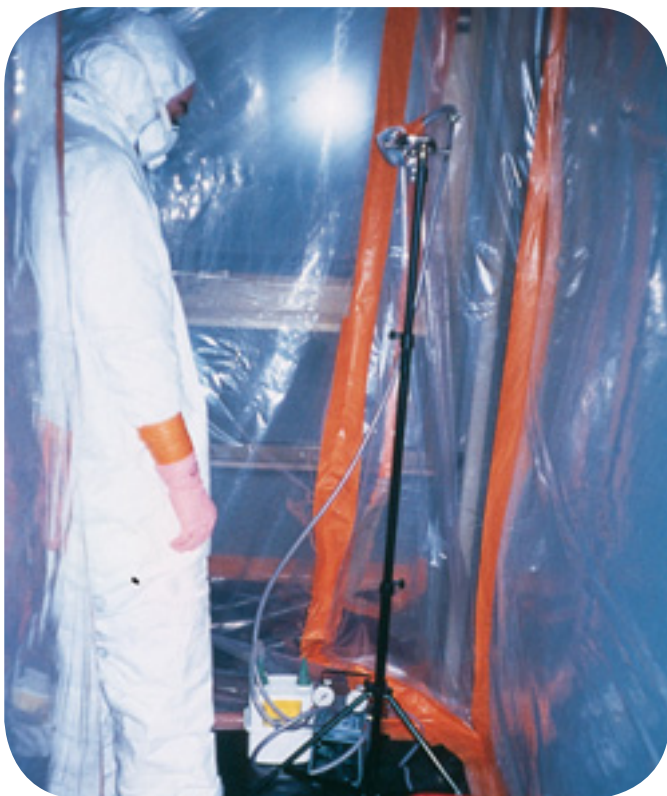
Matériel de prélèvement d'atmosphère constitué d'une pompe et d'une tête de prélèvement.
